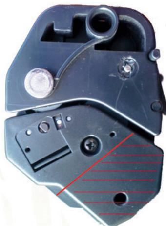
Рис. 4. Здесь делаем трепанацию крышки картриджа
