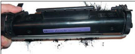
Рис. 13. И очищаем от содержимого бункер отработки
