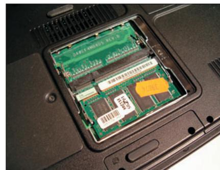
...и снимаем крышку отсека
