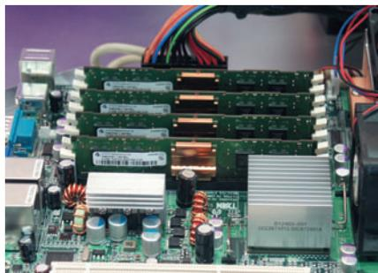
Работающая система с модулями FB-DIMM
