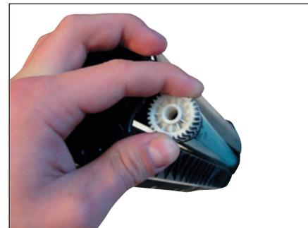
Рис. 18. Аккуратно вынимаем фотобарабан...
