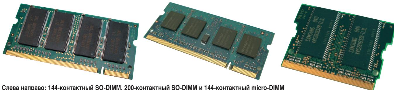
Слева направо: 144-контактный SO-DIMM, 200-контактный SO-DIMM и 144-контактный микро-DIMM
